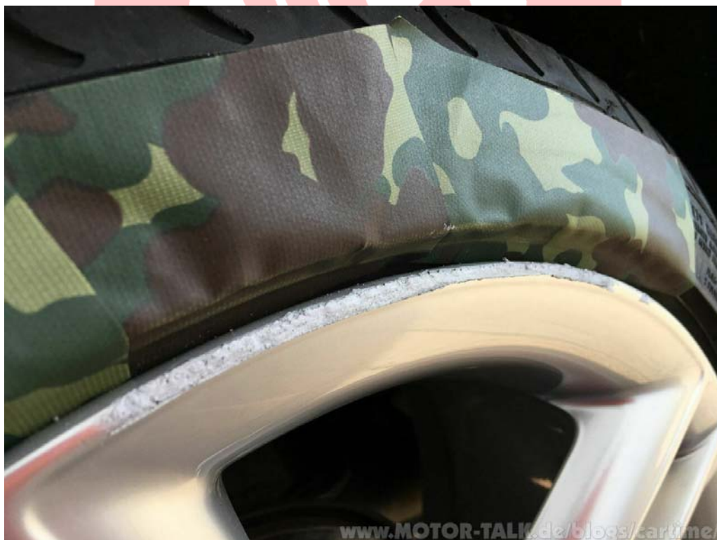
FLÜSSIG-ALUMINIUM aufbringen, glattziehen und trocknen lassen.
