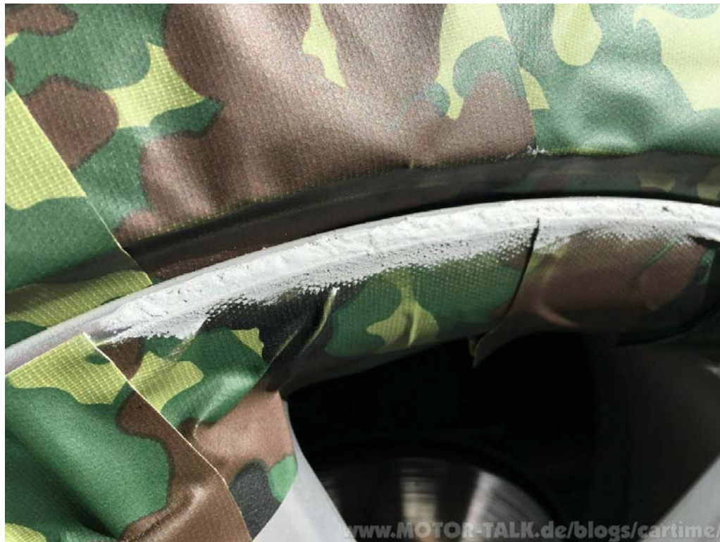
FLÜSSIG-ALUMINIUM aufbringen, glattziehen und trocknen lassen.
