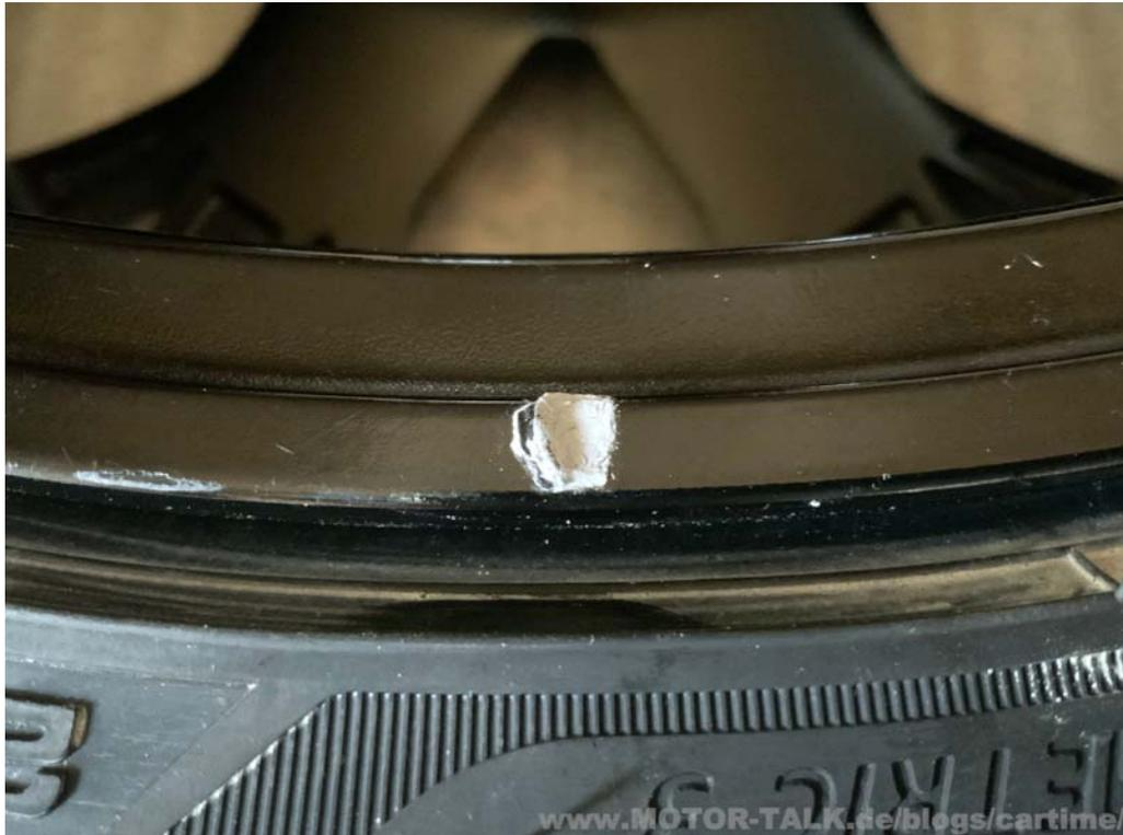
Dickerer Auftrag mit **FLÜSSIG-ALUMINIUM** an Fehlstelle, kann nach dem Durchtrocknen in Form geschliffen und lackiert werden.
