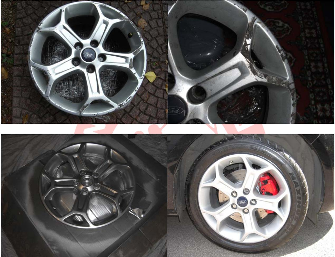
Starke Oberflächenkratzer ausgefüllt mit **FLÜSSIG-ALUMINIUM**, angeschliffen, lackiert.
