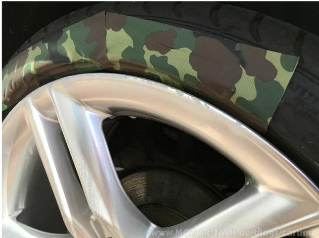
Nach dem nass anschleifen mit 800er, 2000er und 3000er Schleifpapier bereit für eine Lackierung
