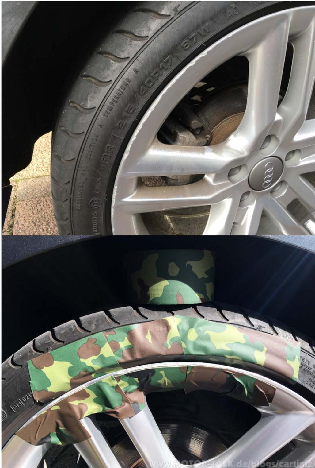
Ableben der Schadstelle, entfetten, Oberfläche anschleifen.
