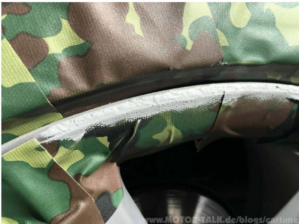
**FLÜSSIG-ALUMINIUM** aufbringen, glattziehen und trocknen lassen.
